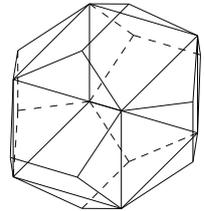
残りの部分は6個の合同な図形になります。この図形の正方形を底面としたときの高さを求めましょう。この図形は2つの四角錐と1つの横倒しにした三角柱に分割できます。この四角錐をさらに合同な2つに分割すると、底面は  $\alpha$ ,  $\alpha - \frac{1}{2}$  の長さを2辺とする長方形で、四角錐の頂点は長方形の1つの頂点の真上にあります。長方形の反対側の頂点と結んだ辺が正十二面体の辺ですから、高さを  $h$  とすると三平方の定理の応用で、 $\alpha^2 + \left(\alpha - \frac{1}{2}\right)^2 + h^2 = 1$  となるから、 $h^2 = \frac{3}{4} + \alpha - 2\alpha^2 = \frac{1}{4}$  したがって、高さ  $h = \frac{1}{2}$  です。
