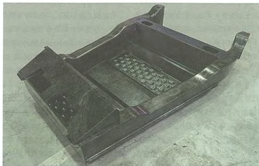
図3 ロータスエリーゼのアルミ合金製シャシの CF RTP 化 フロアパネル (2m)、サイドシル (2m 長)
