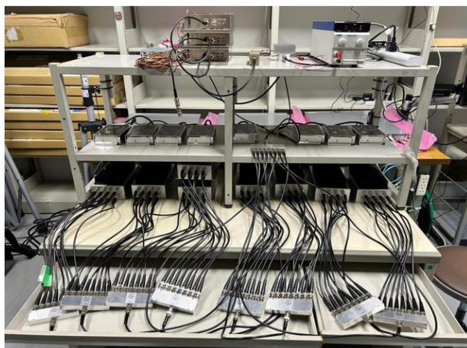
**デジタル信号処理装置**：64系統の信号をアナログデジタル変換器でデジタル化し、FPGAを連結した信号処理装置で合成する試作機。FPGAを連結することで、無限に入力信号を増やすことができる。
